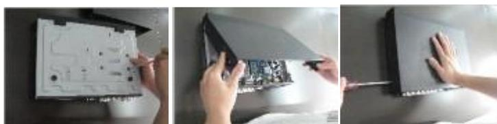
☒☒ Fissare la vite del disco rigido ☒☒ Chiudere il coperchio ☒☒ Installare le viti su entrambi i lati del guscio
