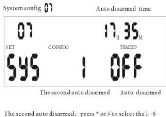
Fig.12: il sistema è in modalità auto disallarmata e il primo controllo verrà fermato alle 17:35.
