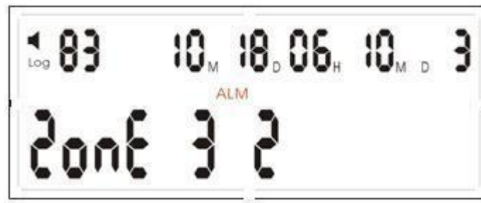
Fig.7: schermo LCD quando sistema allarmato
