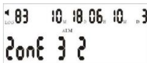
Fig.22: L'LCD mostra quando un rilevatore wireless è allarmato
